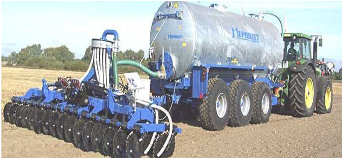
Fot. 12. Aplikator talerzowy firmy MEPROZET (zestaw, urządzenie aplikujące z talerzami)
