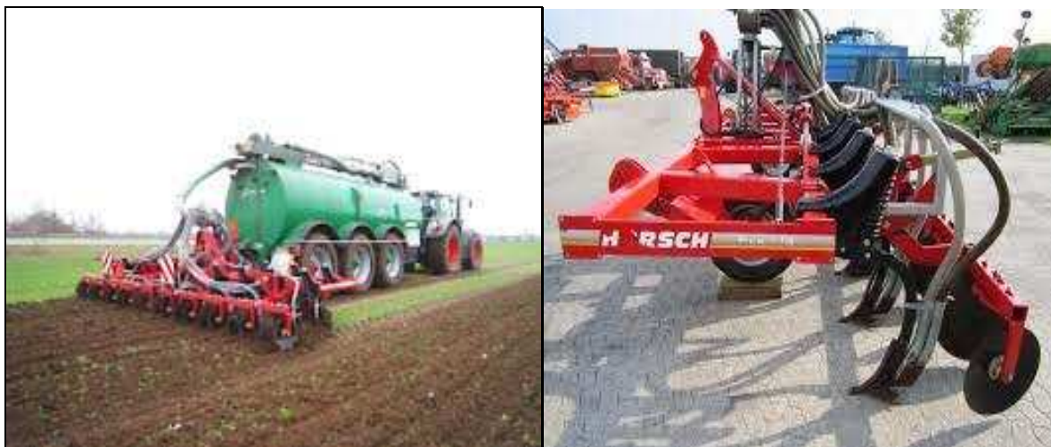
Fot. 10-11. Aplikatur do rozpraszania substratu firmy HORSCH, którym dysponuje gospodarstwo „Ekorol” (z lewej cały zestaw, z prawej urządzenie aplikujące z pługami)
